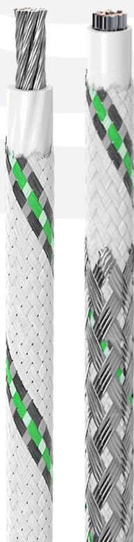
ППСВЛМнг(А)-LS - провод с жилой из медных луженых проволок, с изоляцией из поливинилхлоридного пластика пониженной пожарной опасности, в оплетке из полиэфирных нитей, лакированных, малогабаритный.
