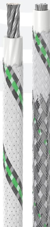
ППСВЛнг(А) - провод с жилой из медных луженых проволок, с изоляцией из поливинилхлоридного пластика пониженной пожарной опасности, в оплетке, из полиэфирных нитей, лакированный.
